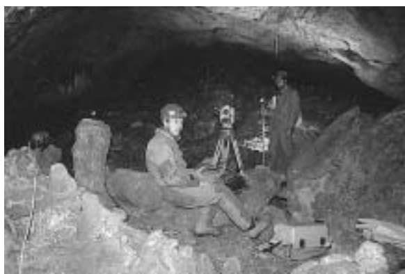
Fig. 2 e 3 - Speleologi e strumentazione topografica in fase di acquisizione dati.
