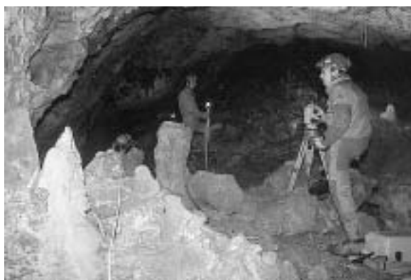
Fig. 2 e 3 - Speleologi e strumentazione topografica in fase di acquisizione dati.
