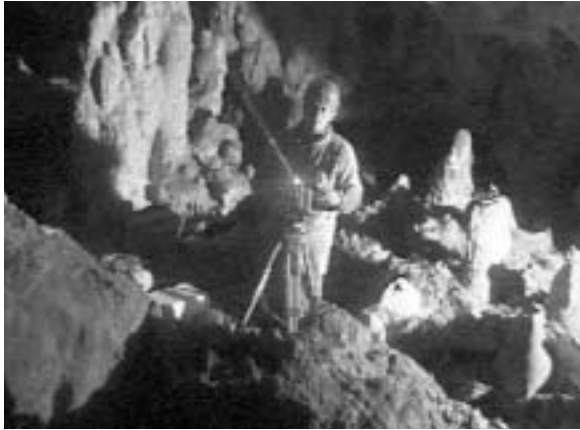
Fig. 4 e 5 - Particolare di due sequenze relative alle operazioni di puntamento mediante l'utilizzo di "tracciante" laser.
